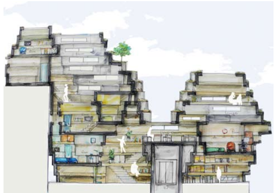
断面:寮には既存建物の縦動線を利用してアクセスする。共同の食堂やリビングに外部の人を招き入れ、料理や外国語などを通して寮の住人である外国人と日本人の交流が広がる。内部での層の段差は家具、棚にもなっている。
