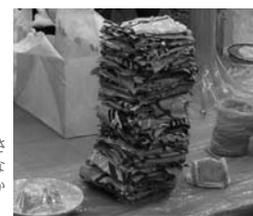
面材である布を積層させ、重みだけで隙間をなくした容器を作るかの実験。
